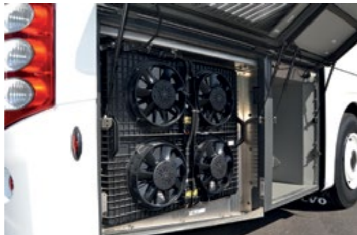
Sähköflektit moottorin molemmin puolin huolehtivat jäähdytyksestä. Bittiohjatusti tietenkin.
