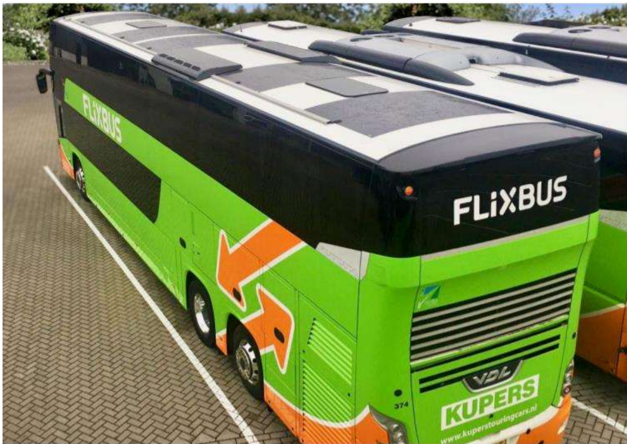
Kuva 1 Aurinkomatot sijoitettu huomaamattomasti VDL kaksikerrosbussin katolle. Kuva: Flixbus
