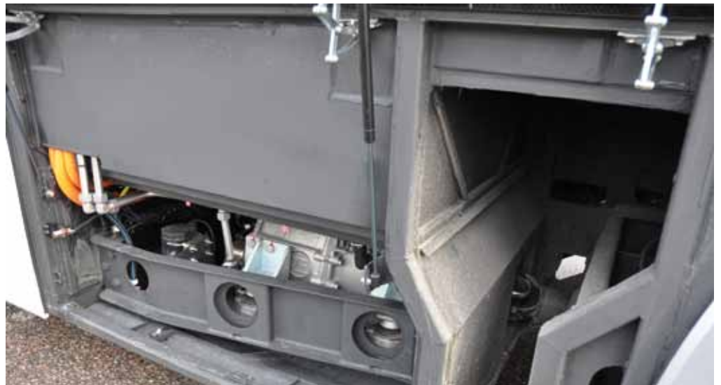
ZF:n sähkömoottori. Sen takana oleva tila on tarkoitettu lisävarusteena saataville hiekoituslaitteille.
