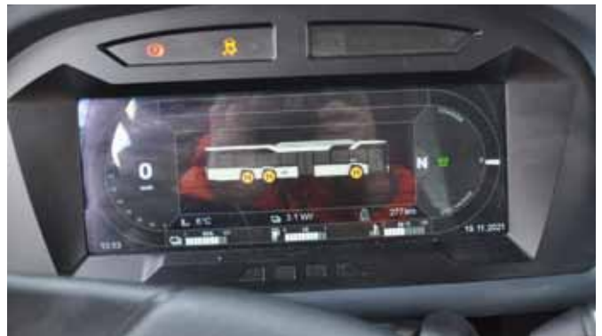
Mittariin tulee näyttö mm. sähkötilanteesta ajoon vaikuttavana tekijänä.
