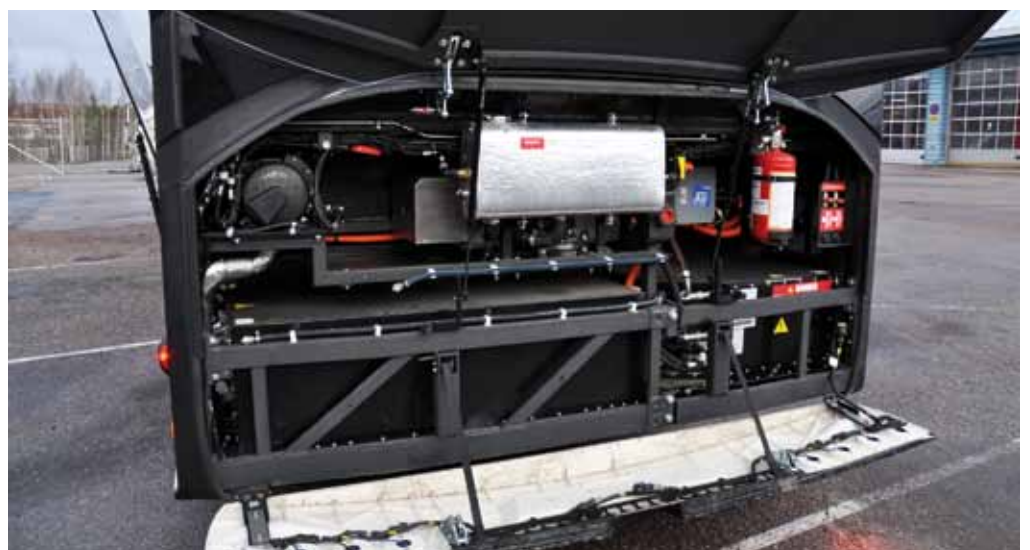
Takaosassa on vahvistettu suojaus.
