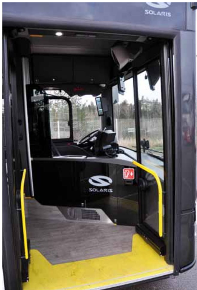
Kuljettajan työpaikka avautuu magneettilukko-oven takaa.
