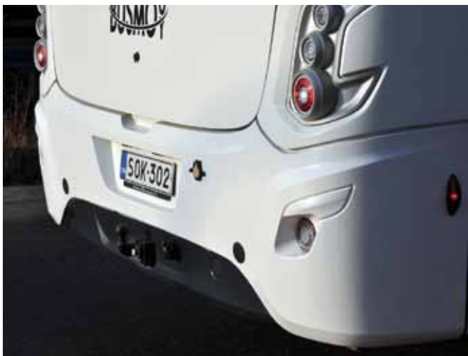
Vetokoukku ei ole kovin yleinen varuste Suomessa, mutta antaa lisää vaihtoehtoja tarpeiston kuljettamiseen
