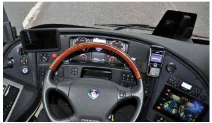
Alusta Scanian hallintalaitteet ovat totutuilla paikoillaan, UNVin painikkeet on hyvä opetella erikseen.
