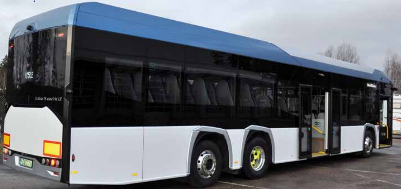
Ovet ovat suuret, invaramppi on keskioivella.
