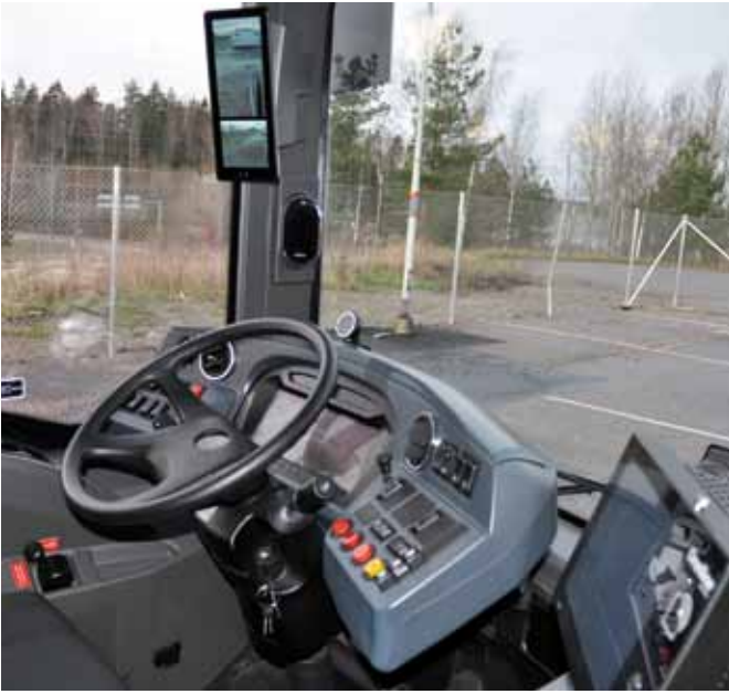
Ohjaamossa on kaikki tarpeellinen. Peilit ovat kamerapohjaisia ja näyttössä on kaksi kuvakokoa.
