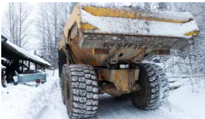
Dumpperin pyörät on tehty kovaan käyttöön. 17-18 kuution kuormatilaan kertyy painoa huomattavan paljon
